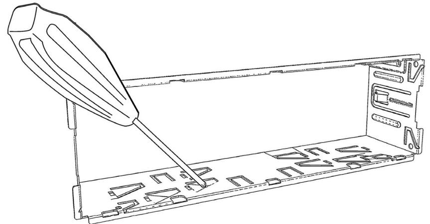
Drücken Sie mit einem Schraubendreher die Laschen nach außen, die so dicht wie möglich am Rand des Ausschnitts sind, um den DIN-Rahmen im Armaturenbrettausschnitt zu fixieren.
