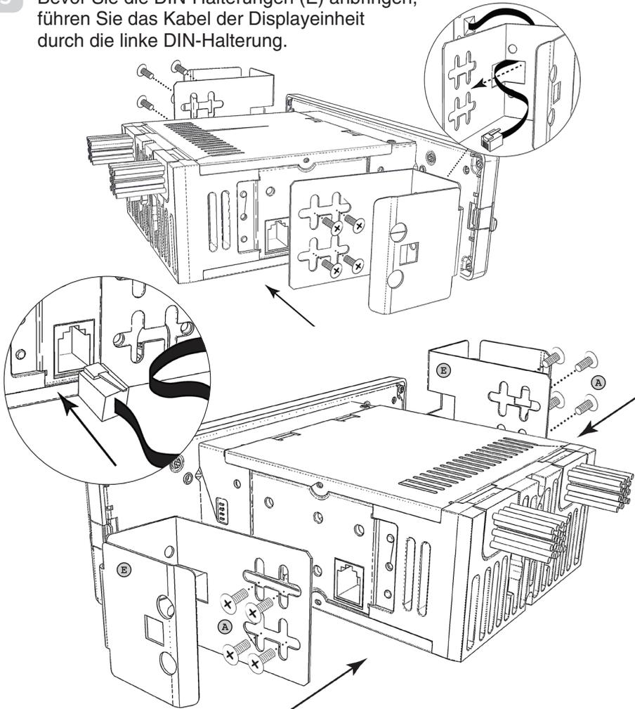
Montieren Sie die DIN-Halterungen (E) (im Lieferumfang des DIN-Kits enthalten) mit den 8 Schrauben, die im Lieferumfang des Radio Grundmoduls enthalten sind, an den Seiten des Radio Grundmoduls. Passen Sie die Halterungen nach vorne an, bis sie die Rückseite der Displayeinheit berühren. Achten Sie darauf, die Halterungen nicht zu verbiegen, um einen korrekten Sitz im DIN-Rahmen zu gewährleisten. Stecken Sie das Kabel der Displayeinheit in das Grundmodul ein.
