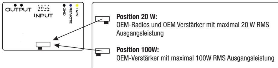
Der **HLC 4 EM** besitzt eine automatische Signalerkennung (**SE-Technik**). Diese wird benötigt, wenn der OEM-Ausgang kein überlagerndes Gleichspannungssignal besitzt. Der High-Low-Adapter erkennt dieses vollautomatisch.
