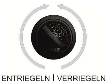
Das beiliegende Ausbauwerkzeug greift mit den Nasen in die Löcher des Hochtönergitters. Durch drehen nach links wird der Hochtöner in der Halterung verriegelt, durch drehen nach rechts entriegelt.
