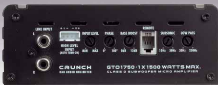
Die Endstufen sind sehr gut ausgestattet, daher drängen sich die Anschlüsse und Regler auf den kleinen Frontplatten
