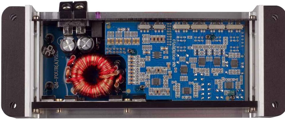
Links das Netzteil mit Stromklemmen, Trafo und MOSFETs am Gehäuse, rechts die Signalplatine
