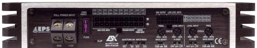
Alle Signal- und Lautsprecherverbindungen sind in zwei Molex-Steckverbindungen gebündelt
