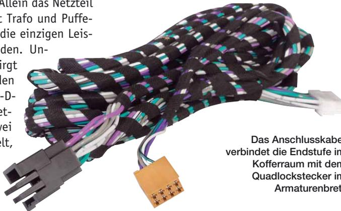
Das Anschlusskabel verbindet die Endstufe im Kofferraum mit dem Quadlockstecker im Armaturenbrett
