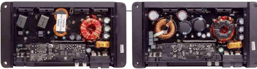
Doppelseitig bestückte Platinen und großzügig dimensionierte Class-D-Schaltungen sorgen für Leistung und ungestörten Radioempfang
