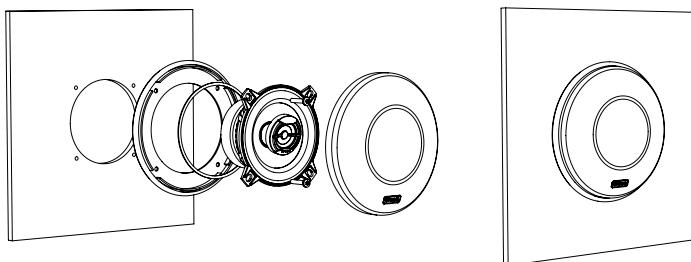
**Grille installation** / montage de grille / установка с защитным грилем
