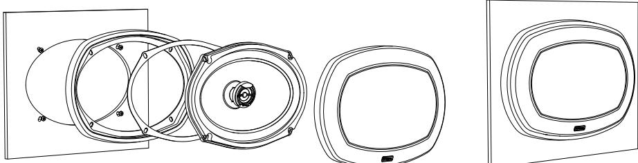
**Grille installation** / montage de grille / установка с защитным грилем
