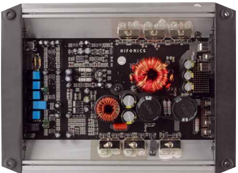
Die Mercury IV v2 (oben) ist eine klassische, diskret aufgebaute Class-AB Schaltung
