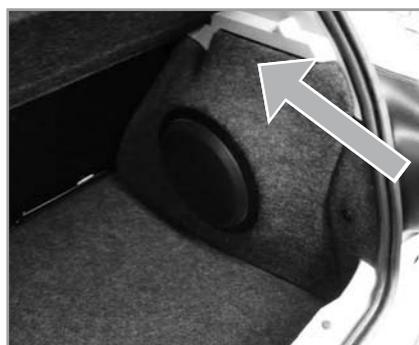
Pressen Sie das Subwoofergehäuse kräftig im rechten Stauraum an die Innenwand, so dass die beiden Klettbandklebebandstreifen fest verbunden sind.
