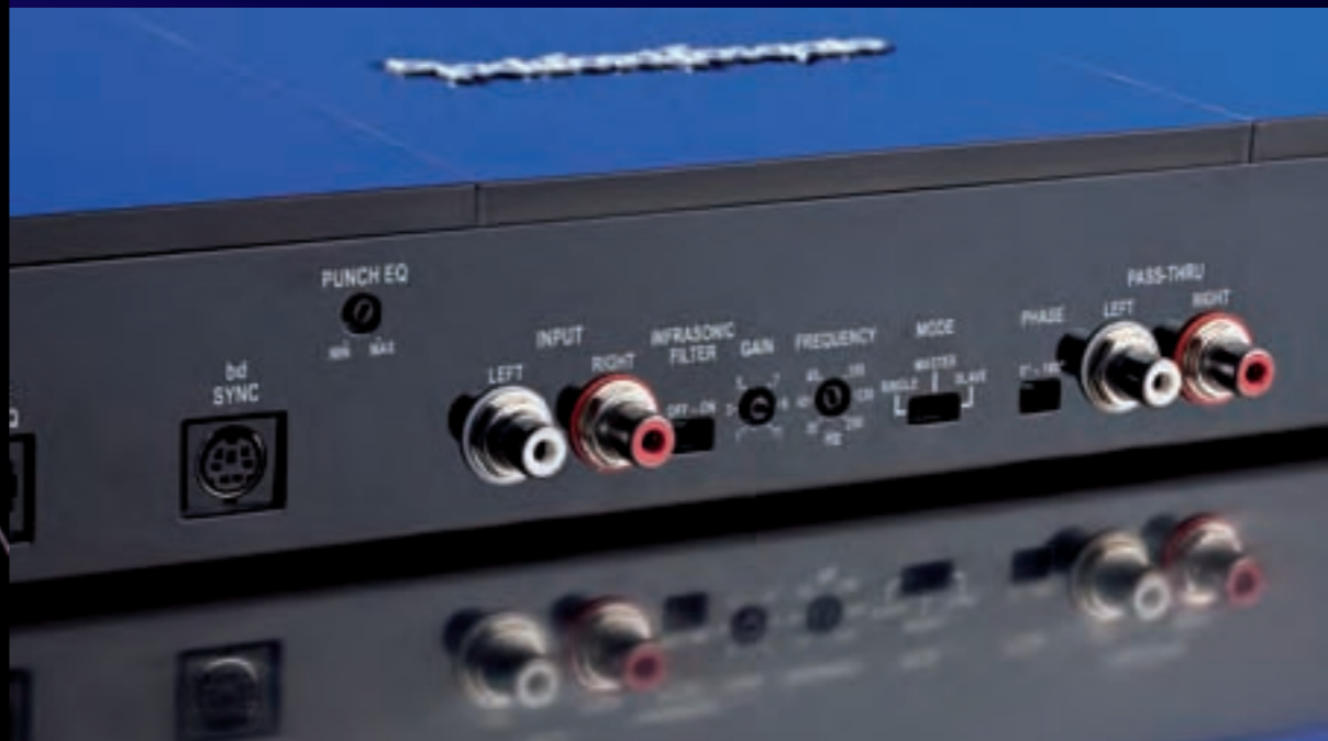
Pumpe: Der Linedriver pumpt das Eingangssignal auf bis zu 22 Volt im Balanced-Modus auf, um Störungen effektiv zu vermeiden.
