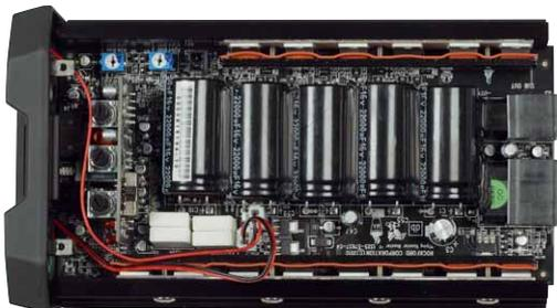
Vollgepackt mit Bauteilen und trickreichen Schaltungen. Die Mono (unten) kommt ohne Trafo aus und besteht fast nur aus Pufferelkos
