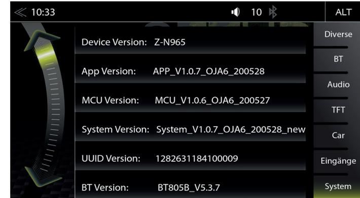
Im System Setup Menü unter Software Version Info sehen Sie die sich aktuell auf dem Z-N965 befindliche Software, mit Versionsangaben zu MCU, OS, APP, MPEG und UUID.
