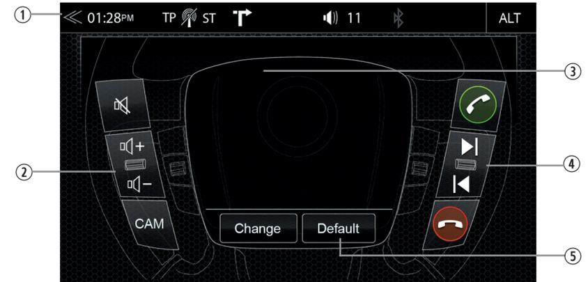
Das ZENEC Gerät ist für ihr Fahrzeug (siehe Kompatibilitätsliste) bereits vorkonfiguriert und die LFB kann direkt benutzt werden wenn das Fahrzeug über die Key1/Key2 Kabel am Gerät angeschlossen wurde. Über die Geräteeinstellung (siehe Seite 61 "SWC Anlernung"), können Sie diese Ansicht öffnen, die vorbelegten Tasten einsehen oder Änderungen durchführen.
