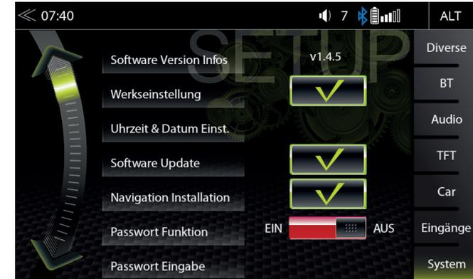
Im System Setup Menü können Sie diverse Einstellungen vornehmen, wie z.B. Anpassung der Uhrzeit, laden der Werkseinstellungen, ausführen von Software Updates oder auch setzen eines Passwortes.
