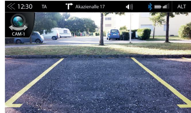
Wenn am Kamera Eingang des Geräts eine CVBS fähige Kamera angeschlossen ist, startet das Antippen des Kamera Icons den manuellen Rückfahrkamera Modus.
