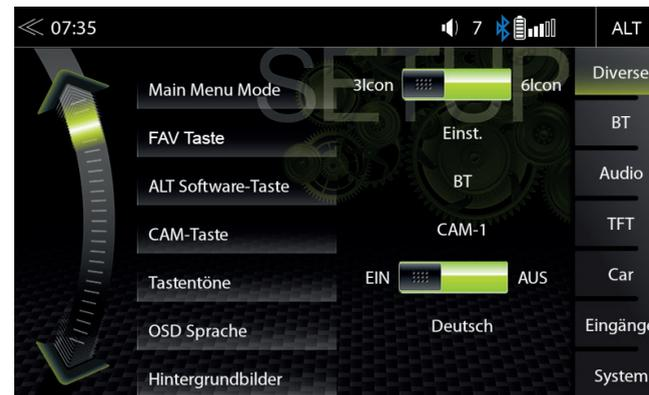
Im Diverse Setup können Sie Einstellungen für den Anzeigemodus mit 3 oder 6 Icons, EIN oder AUS der Beep-Sounds sowie die LED Farbe (amber / weiß) der Tastenbeleuchtung an der Gerätefront auswählen.
