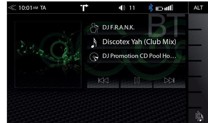
Die A2DP RVC Anbindung erlaubt die Play, Pause und Skip Kontrolle von gepairten mobilen Endgeräten, welche sich im Audio Wiedergabe Modus befinden. Die Anzeige von iD3-Tag Metadaten ist nur möglich, wenn diese auf den vom Smartphone gestreamten Titeln vorhanden sind.
