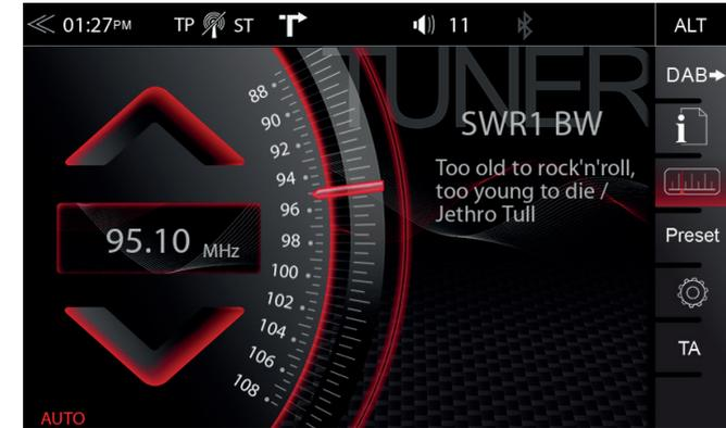
Im FM Setup (Zahnrad Icon) kann den Senderfrequenz-Pfeilen eine manuelle (100kHz Schritte), oder auto Scan Funktion (bis zum nächsten Sender) zugewiesen werden. Siehe S.18.
