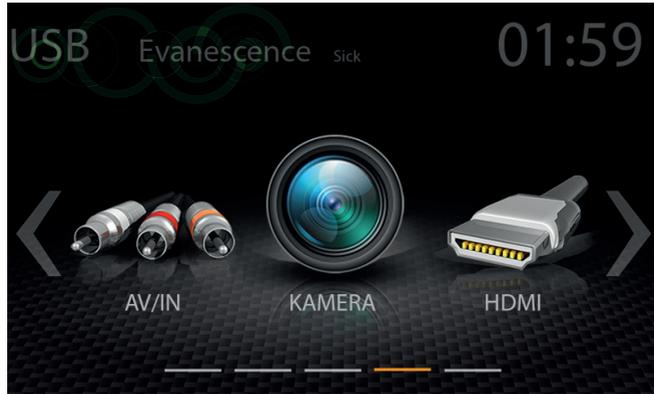
Wenn am HDMI Port des Geräts eine kompatible HDMI Quelle wie z.B. Videogame, Smartphone, Tablet, Notebook angeschlossen ist startet das Antippen des HDMI Icons die HDMI Quelle.
