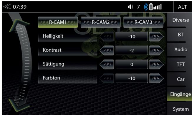
Im Inputs Setup Menü können Sie auf die Bildwiedergabe Parameter von angeschlossenen Video Quellen wie z.B. Rückfahrkameras Einfluss nehmen. Kontrast, Helligkeit, Farbsättigung und Farbton können angepasst werden.
