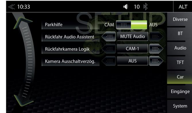
Im Car Setup Menü können Sie einstellen, wie das ZENEC Gerät auf im Fahrzeug vorhandene optionale Komponenten wie Kameras und Einparkhilfe interagiert.
