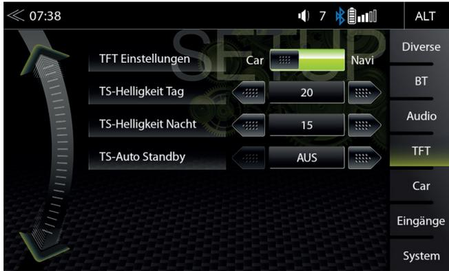
Im TFT Setup Menü können Sie Bildschirm Einstellungen vornehmen, welche die Tag / Nacht Helligkeitsumschaltung des Bildschirms steuern. Die Einstellung „Navi“ ist nur mit der microSD Karte mit der Navigationssoftware von ZENEC möglich.
